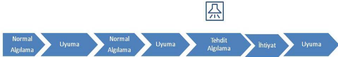
Şekil 2. Enerji tasarrufu sağlayacak şekilde tasarlanan Algılayıcı birim yaşam döngüsü.
